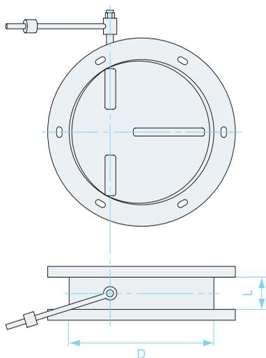
Взрывозащищенный клапан предназначен для использования в системах, в которых перемещаются взрывоопасные смеси всех категорий и групп по классификации ГОСТ 12.1.011, и устанавливаются во взрывоопасных зонах помещений, относящихся к классам В-1, В-1А, В-1Б по классификации ПЭУ. Изготовлен из черной стали.
