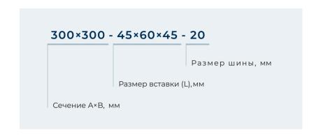
Гибкая вставка применяется при перемещении воздуха, не содержащего агрессивных примесей. Вставку можно применять при температурах окружающего воздуха от –40 °C до +80 °C.
